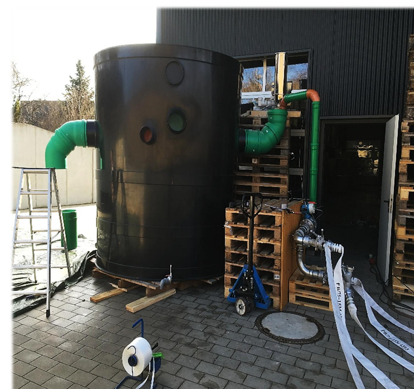
Hydrodynamischer Abscheider auf dem Prüfstand
